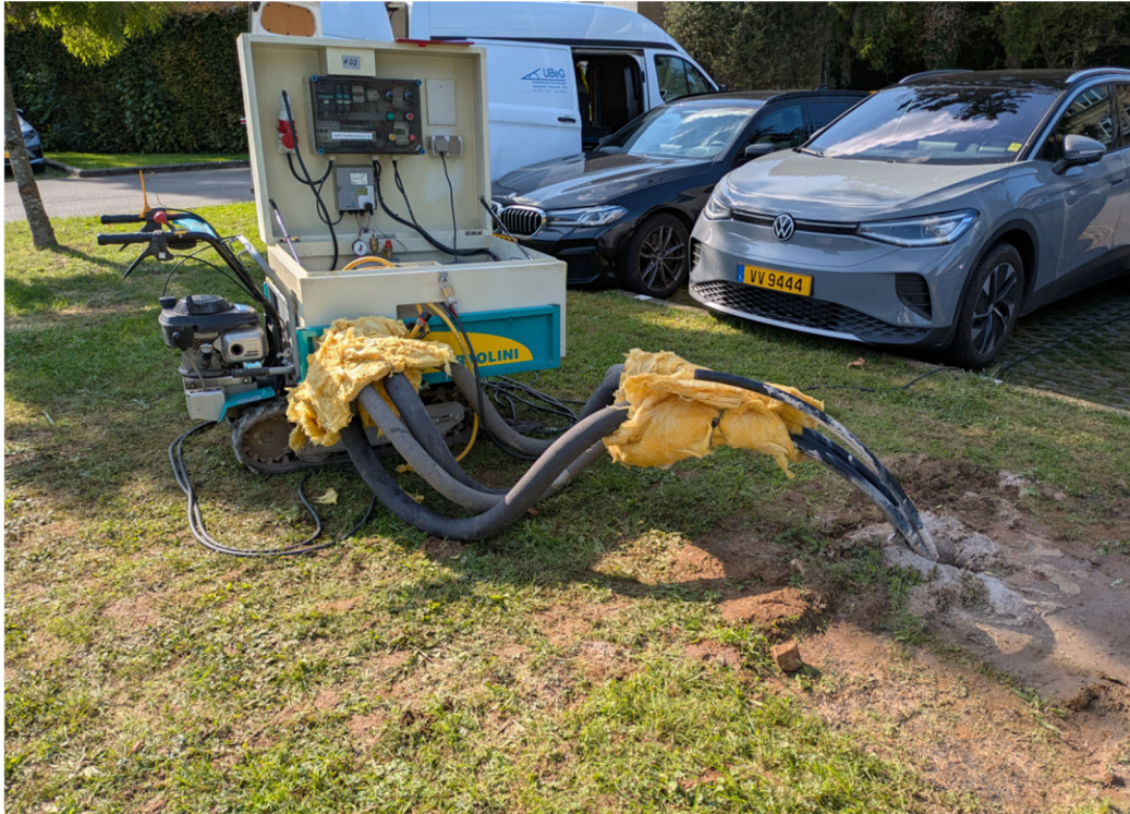
Foto 1: Durchführung des Geothermal Response Test
